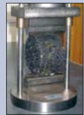
Prova di trazione indiretta (©BRR)
