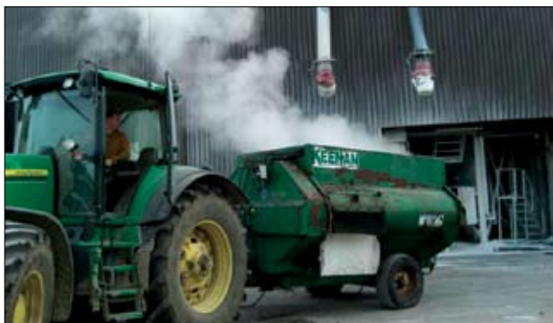
Figur 2: Homogenisering av gödsel och kalk utanför byggnaden. (Storbritannien) Värmeutvecklingen genererar ånga.
